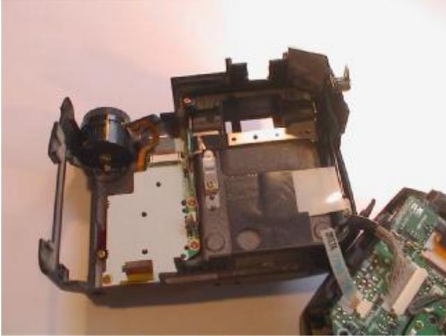
Links oben könnt Ihr den Mode Dial sehen, doch bevor dieser herausgeschraubt werden kann, müssen noch die zwei Leiterbahnen gelöst werden. Dazu muss die Platine für die Funktions- und Cursortasten gelöst werden.
