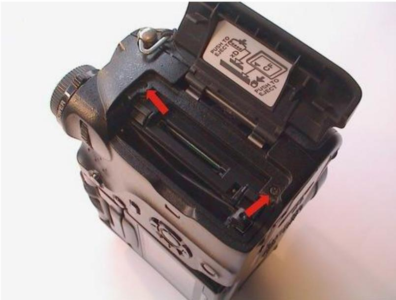
Kamera auf die Linke Seite stellen und die zwei Schrauben unter der Klappe für die Speichermodule herausdrehen.
